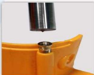
Con el US 400, se pueden realizar varias aplicaciones para ensamblar objetos hechos de material termoplástico. Algunas operaciones posibles incluyen la inserción de piezas metálicas, remachado de pernos y soldadura por puntos para embalaje.
