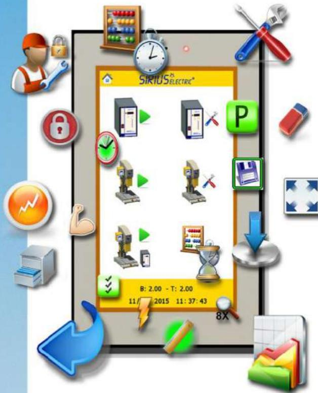
La gestión de la soldadora está a cargo de un sistema con un microprocesador de última generación cuya programación es sencilla y rápida. El panel frontal está equipado con una pantalla táctil. APP combina la facilidad de uso con una gran flexibilidad, lo que le permite gestionar cómodamente todas las funciones de la soldadora y controlar los parámetros del proceso. Con MP2, se pueden realizar las siguientes funciones:
